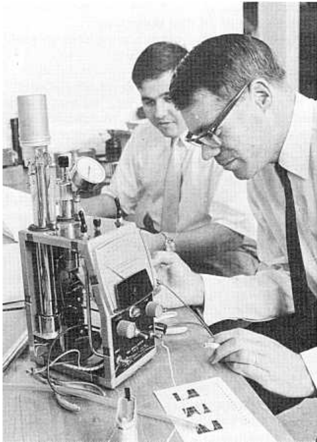
Fig. 2. Aitkenkernenteller. Zijwanden en batterijen zijn verwijderd, zodat de ruimtes I (grote) en II (kleine buis) duidelijk zichtbaar zijn. Verder ziet men aan de buitenzijde van boven naar beneden: de vacuummeter; drie kranen; de meter, met schaalverdeling 0-100 waarbij elk getal een bepaalde kernenconcentratie hoort, die men in een bijgeleverde grafiek kan opzoeken; een controlelampje; twee knoppen voor de nulstelling (grof- en fijnregeling); de aan/uit-schakelaar; de luchtinlaat en de aansluiting voor de pomp.
