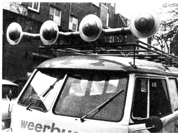
Figuur 2. De weerbus, waarmee de waarnemingen werden verricht. Voorop zijn duidelijk zichtbaar de omhulsels van de thermokoppels met daarachter de blower. Helemaal rechts op de foto de buitenreferentietemperatuur.
