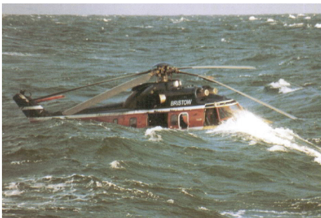
Figuur 4. Na blikseminslag te water geraakte helikopter, 19 januari 1995. De staartrotor is verdwenen, en een hoofdrotorblad is beschadigd. Foto: AAIB.
